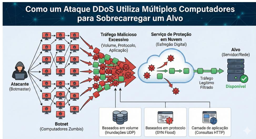
Figura 3.3: Como um ataque DDoS utiliza múltiplos computadores para sobreregar um alvo.
