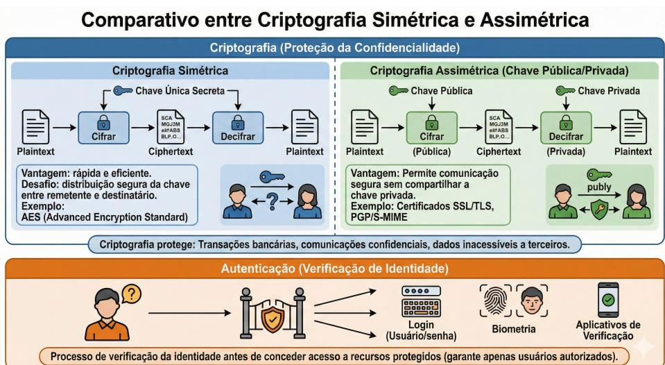
Figura 2.2: Comparativo entre Criptografia Simétrica e Assimétrica.
