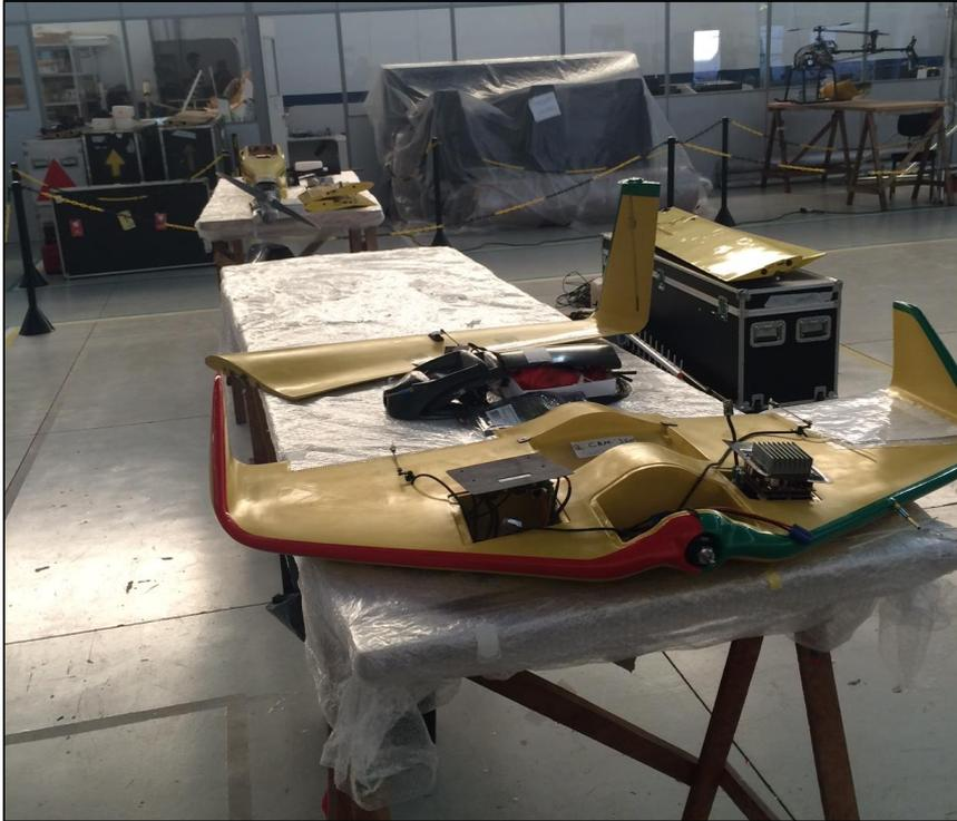
Figura 13: Detalhe para do VANT da Instituição D em sua fase final de produção, separado para entrega ao cliente final, com caixa de proteção para transporte, baterias, carregador de bateria e cabos de transferência de dados (Autor, 2016).
