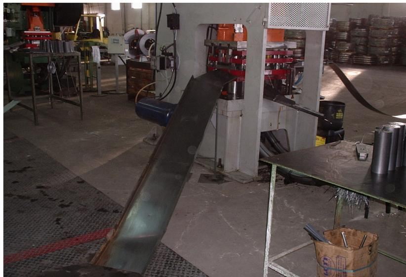
**Figura 4.20 – Esteira do setor de prensas e usinagem após a reestruturação**
