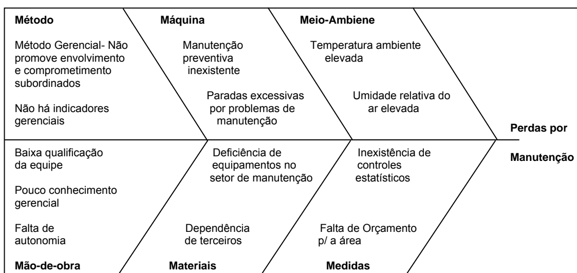
Figura 22 – Diagrama de Ishikawa para a falha interna referente à Manutenção
