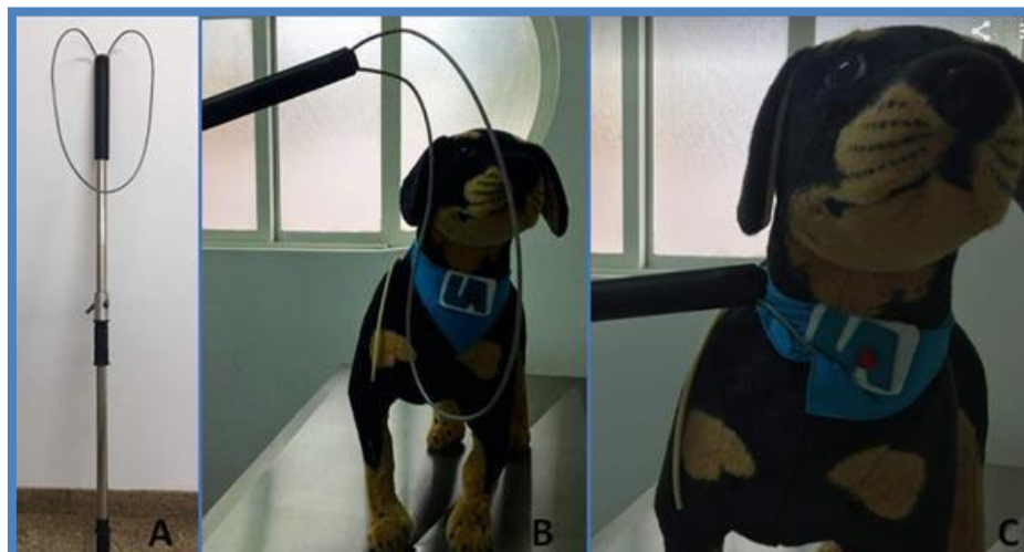
Figura 12. (A) Dispositivo cambão; (B); Simulação da laçada no manequim; (C) Manequim laçado.
