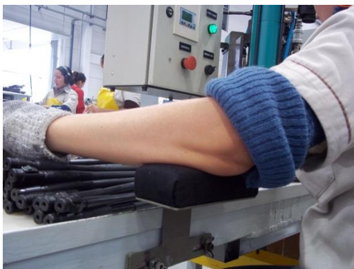
Posição de trabalho do operador após melhoria (final)
