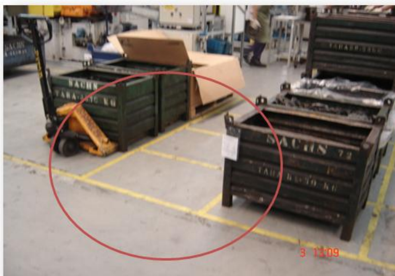
Figura 164: Caixas verdes fora das áreas demarcadas.
