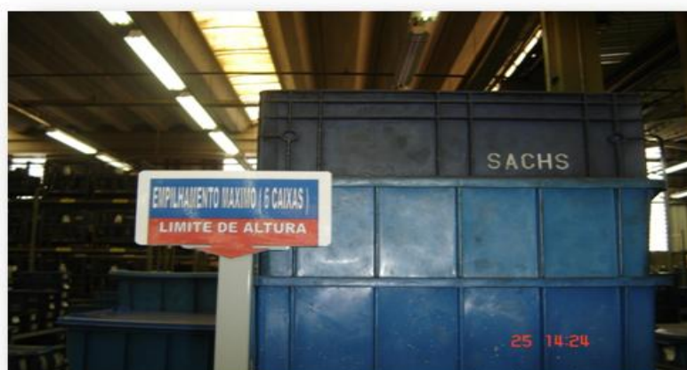
Figura 161: Limite de Empilhamento Excedido.
