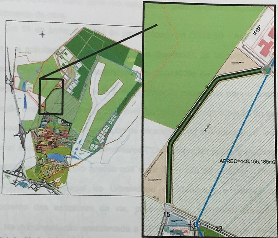
**Figura 7** - Detalhe da Proposta 3 - a estrada foi deslocada para a faixa contígua à área de carregadores (aceiros) já existente.
