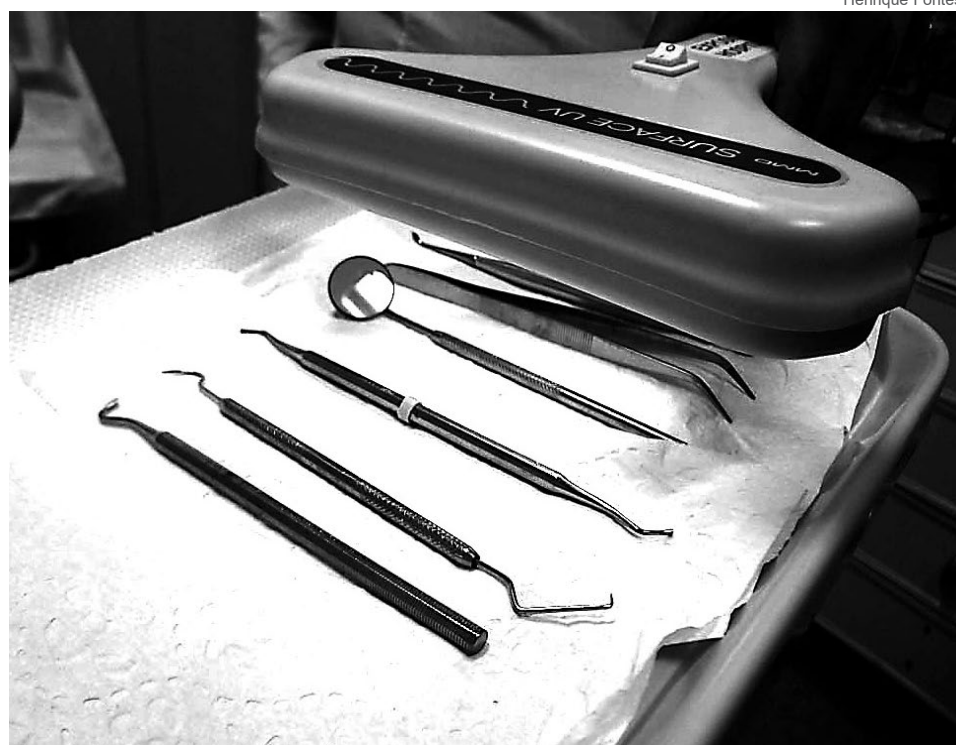
Equipamento usa luz ultravioleta para desinfetar objetos e ferramentas cirúrgicas, além de poder ser usado também em móveis e outras superfícies
