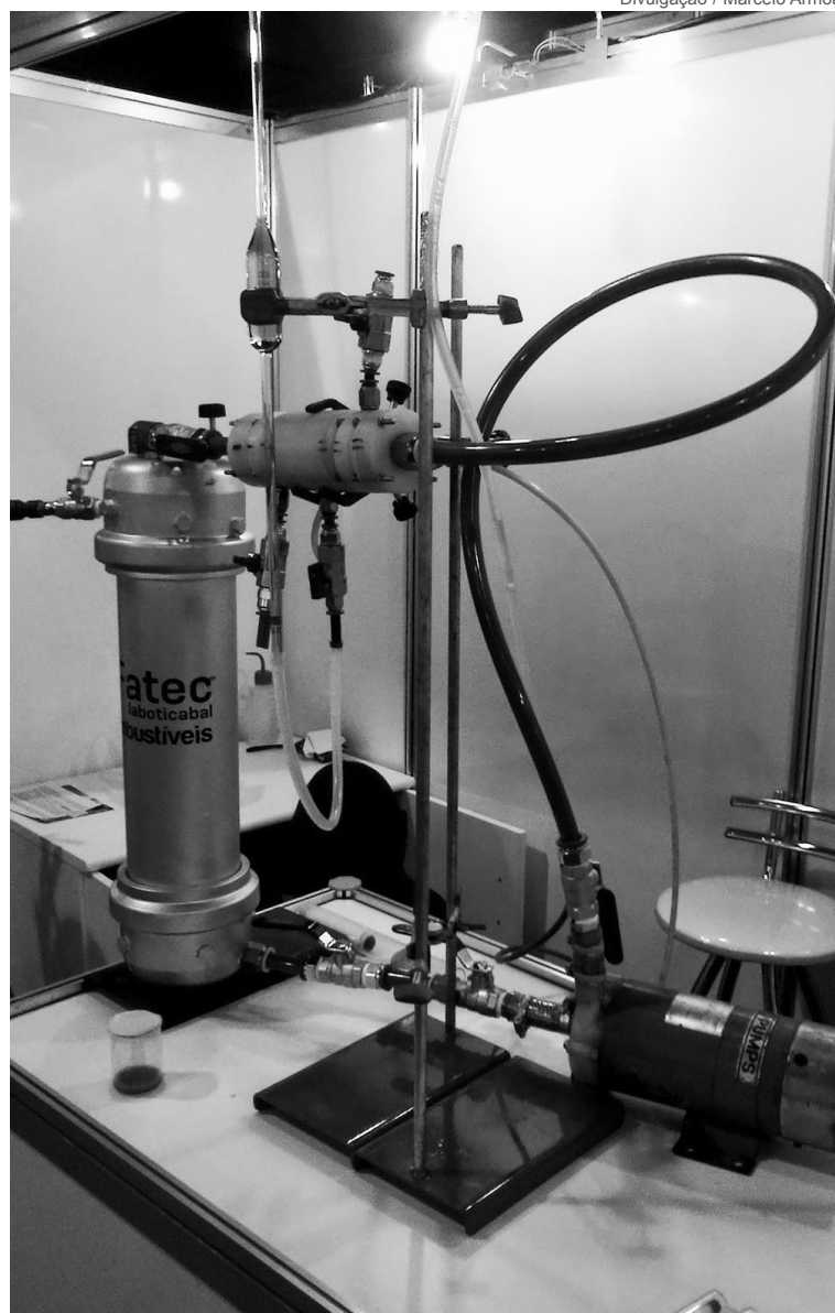
Processo de clarificação é feito através de uma membrana cerâmica sintetizada
